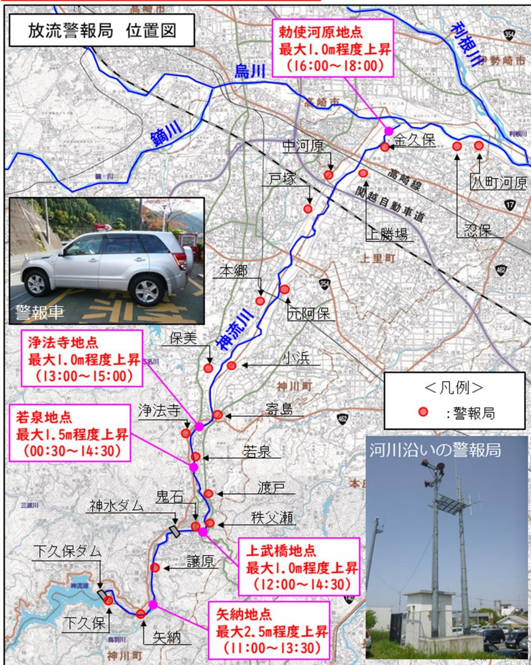
神流川の放流警棒設備と各地点の水位上昇量と時間の目安
